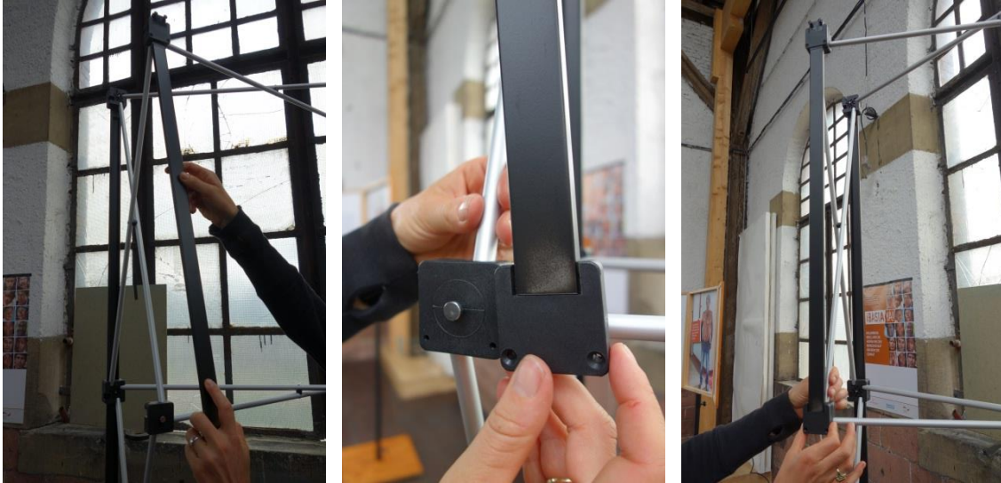
Abbildung 8: Zunächst müssen alle schwarzen Verstärkungsteile eingeführt werden. Dazu werden diese seitlich über den Metallstift gezogen (s. Bild i.d. Mitte)
